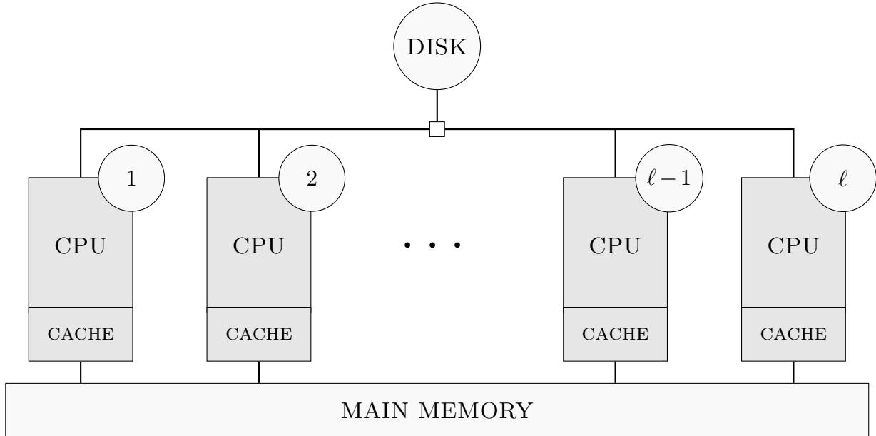
Slika 4.1: Višeprocesorski paralelni računar
