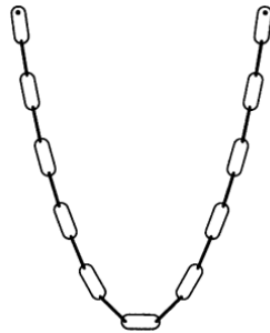
Slika 4.1: Problem lančanice: kriva visećeg lanca
