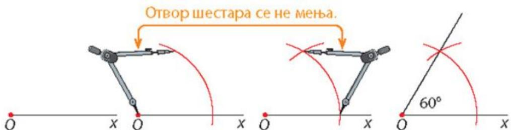
Slika 3: Konstrukcija ugla od  $60^\circ$  (str. 54, [18])
